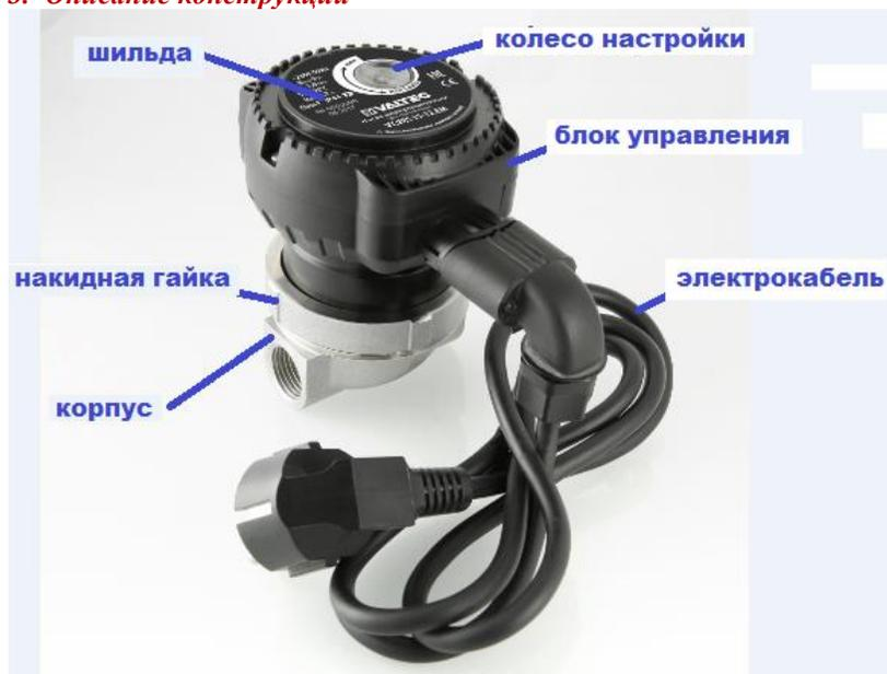
3.1. Циркуляционный насос представляют собой электронасос с однофазным асинхронным электродвигателем со сферическим статором и сферическим «мокрым» ферромагнитным ротором с интегрированным рабочим колесом.
